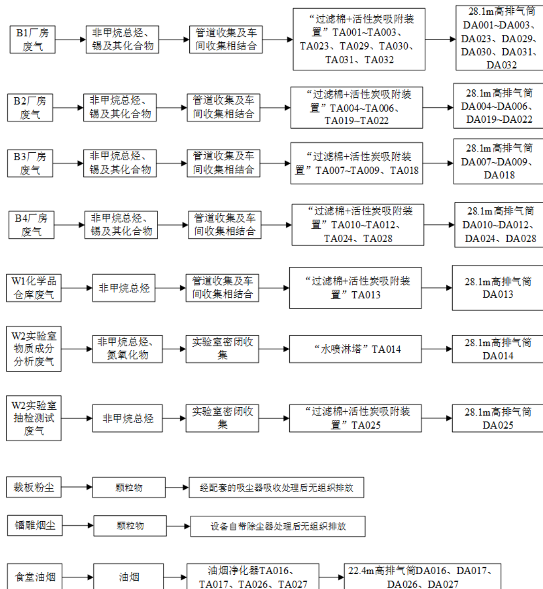
图 1.2-1 变动后全厂废气收集处理情况图
